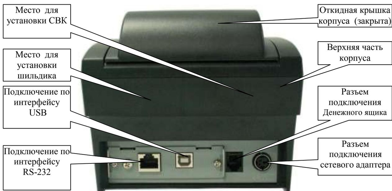
Рисунок 2. Вид ККМ сзади.
